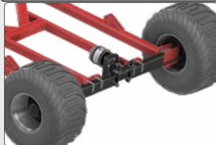
Transporträder 500-50-R17 Hydraulische Bremse
