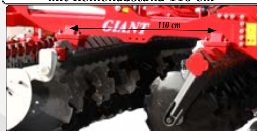
Verstellbare Scheibenreihen mit Reihenabstand 110 cm
